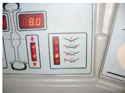
Ведите ширину (значение **L**) и диаметр диска (значение **D**) в память станка, согласно п.п. 4.1.4 и 4.1.5 данной инструкции соответственно.
